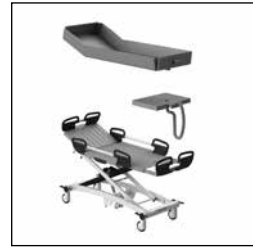
Figuur 20 Demontage ligplaat en matras.
