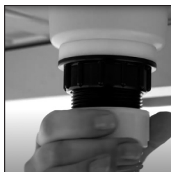
Figuur 23. Vervangen afvoerslang.
